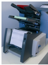
HEFTER Si 3500 - posiada automatyczny podajnik kopert z "widną transportującą" o powiększonej pojemności
